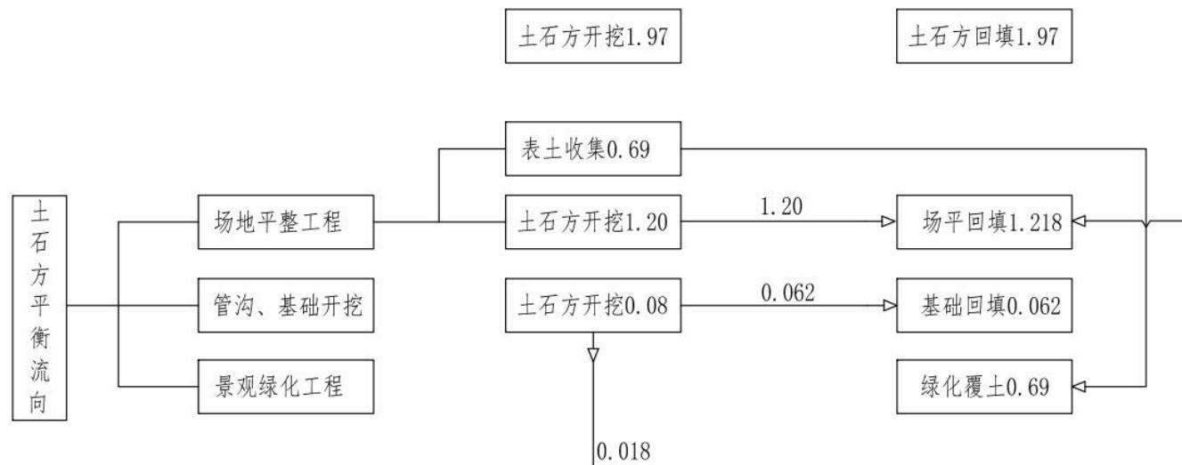
**图 2-5 工程土石方平衡及流向图**
