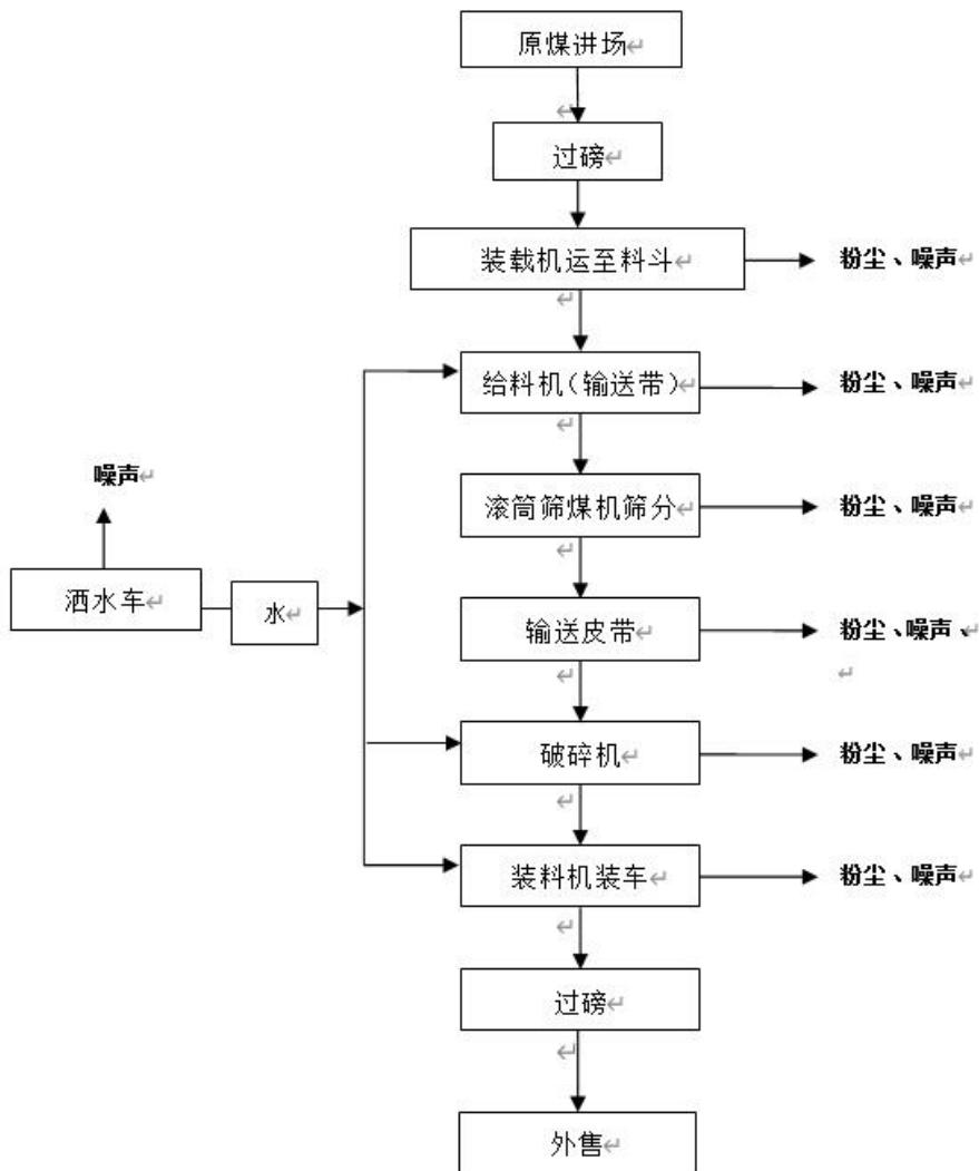
图 2-4 运营期原煤处理工艺流程简图
