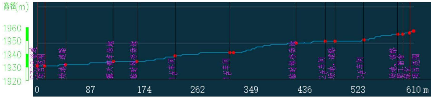
图 2-3 场地 1-1 坡向布置剖面图
